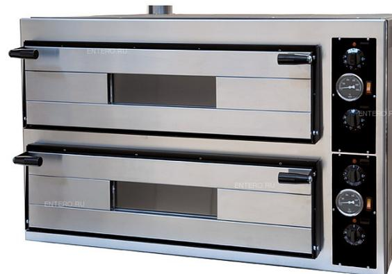
Печь для пиццы **\*\*Arach AMM66\*\*** серии "Medium" используется на предприятиях общественного питания и торговли. Модель оснащена механической системой управления и 4 нагревательными элементами. Лицевая панель выполнена из нержавеющей стали, боковые и задние панели - из окрашенной стали, рабочая камера - из стали с алюминиевым покрытием, под - из огнеупорного камня.
