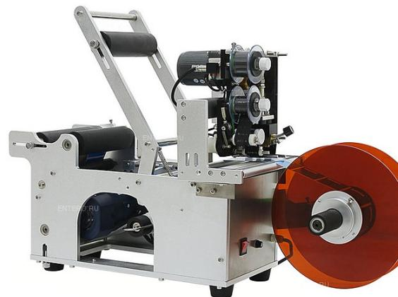
Полуавтоматический этикетировщик **\*\*Hualian MT-50\*\*** используется на производственных площадках, предприятиях пищевой, фармацевтической, химической, косметической промышленности для нанесения самоклеющейся этикетки на круглую тару. Оператор помещает продукт на валики, затем закрывает упор и аппарат автоматически прокатывает, одновременно нанося этикетку на продукт. Модель оснащена датером для проставления даты.
