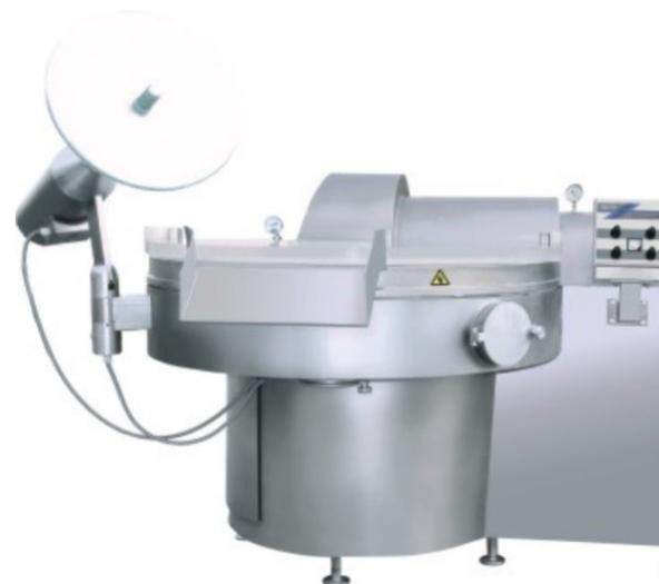
Модель ZBZ125 представляет серию профессиональных высокоскоростных вакуумных куттеров для пищевой промышленности ZBZ. Объем чаши в данной модели составляет 125 л, материал изготовления – полностью нержавеющая сталь. Раздельные приводы ножевого вала и чаши обеспечивают высокую надежность работы и позволяют выбрать оптимальный режим работы для конкретного сырья.
