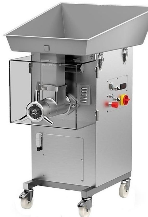
Мясорубка напольная с охлаждением **\*\*Minerva C/E 800 R Unger S5 380 В\*\*** используется на предприятиях общественного питания и торговли для приготовления мясного и рыбного фарша и колбасных изделий. Модель оснащена системой охлаждения, тремя решетками и двумя самозатачивающимися ножами и двумя кольцами. Корпус, загрузочный бункер, опоры с колесами и горловина шнека выполнены из нержавеющей стали AISI 304, решетка, нож - из нержавеющей стали.
